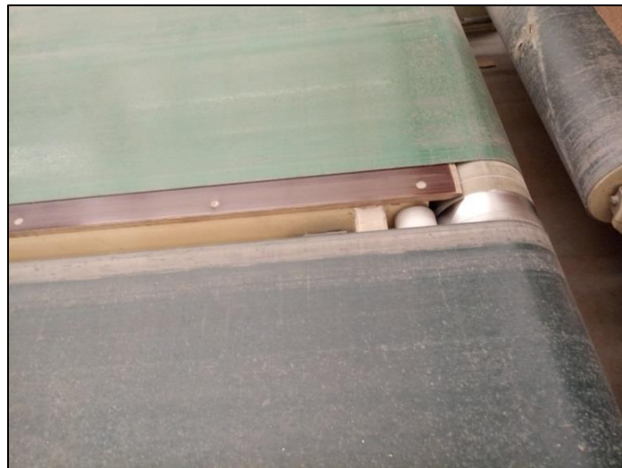
Figura: 3.12 Cintas transportadoras mal posicionadas
