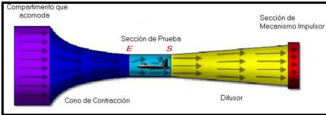
Figura 2: Diagrama de las secciones del Túnel de Viento.
