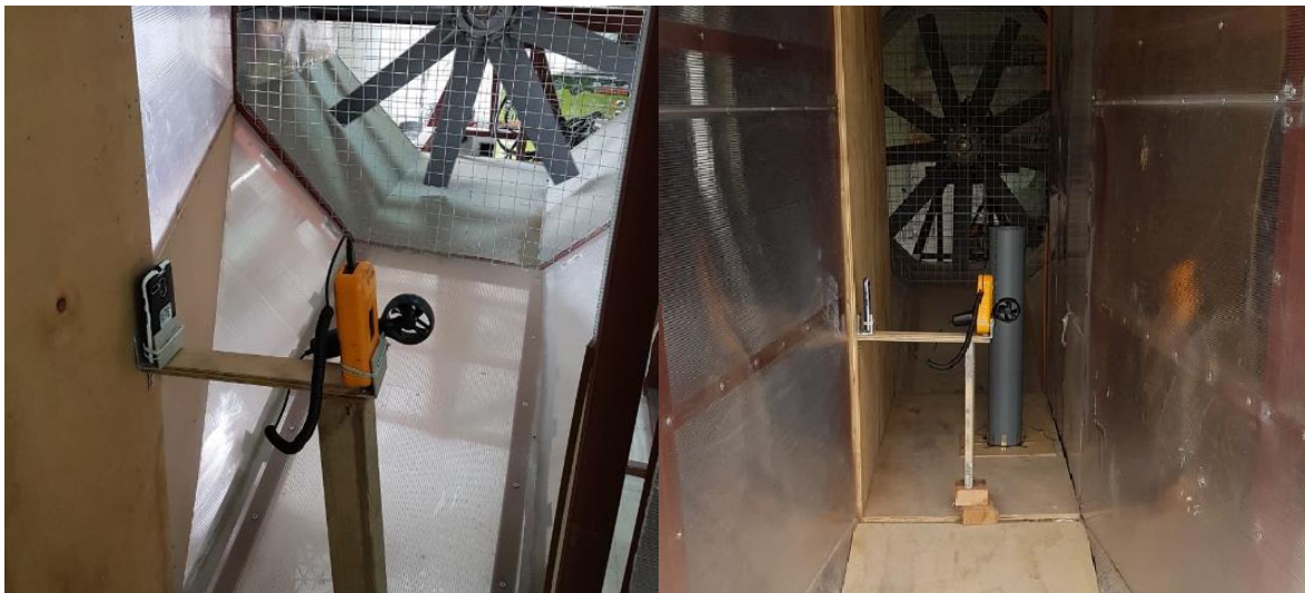
Figura 5: Medición de la velocidad a diferentes alturas.
