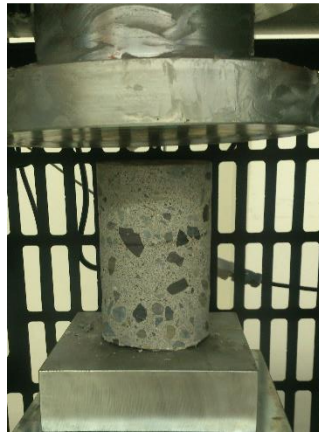
Figura 10: Testigo de hormigón D10, antes del ensayo de compresión.
