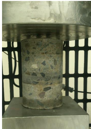
Figura 11: Testigo de hormigón A9, antes del ensayo de compresión.
