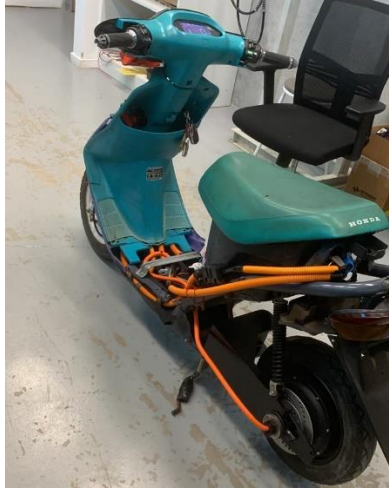
Figura 43 Conexionado de alto voltaje; Fuente [E.P]
