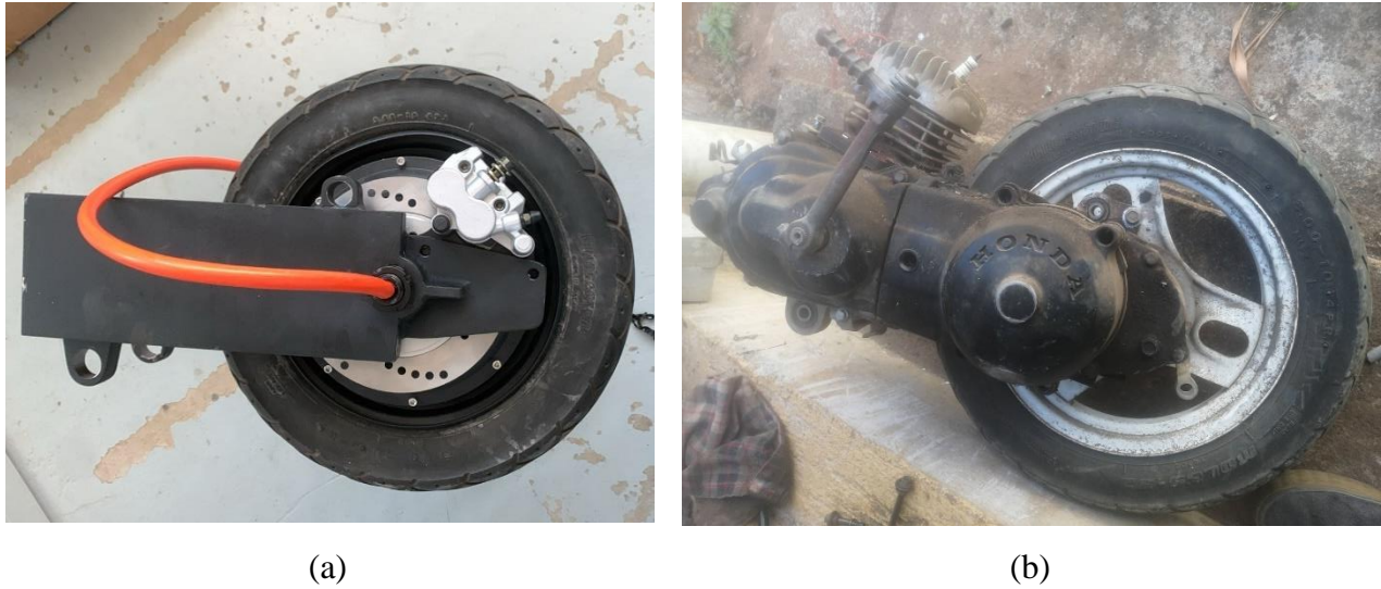
Figura 37 Instalación Motor rueda con soporte trasero; Fuente [E.P]
