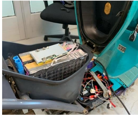
Figura 78 Presentación pack sin carcasa en moto scooter; Fuente [E.P]
