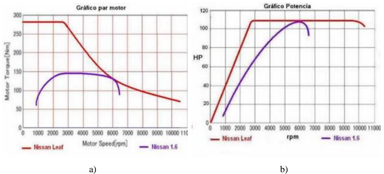
Figura 7 Grafico curva par y potencia Nissan Leaf en comparación motor C.I.; Fuente [27]
