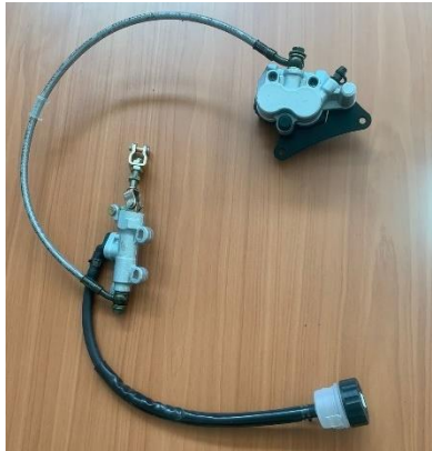
Figura 36 Sistema de frenado trasero; Fuente [E.P]
