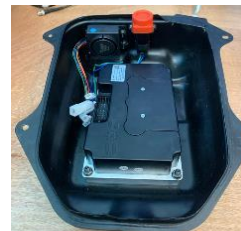
Figura 39 Instalación Controlador en moto scooter; Fuente [E.P]
