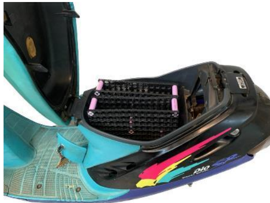
Figura 70 presentación soporte batería en moto scooter; Fuente [E.P]
