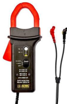
Figura 94 Sonda de corriente AEMC MR416; Fuente [73]
