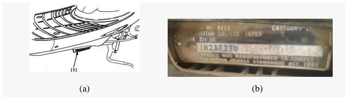
Figura 8 Ubicación información chasis; Fuente [24]
