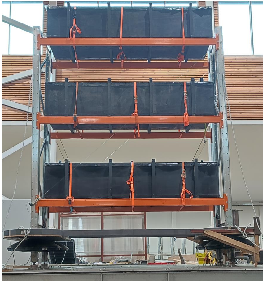
Figura 6: Rack montado sobre sistema de aislamiento, en mesa vibradora. Fuente: Elaboración propia.
