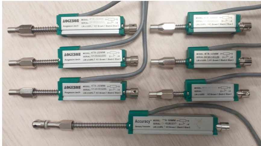
Figura 16: Instrumentos de medición de desplazamientos con recorridos entre de 10, 25 y 50 mm, adquiridos con posterioridad al término de este proyecto.
