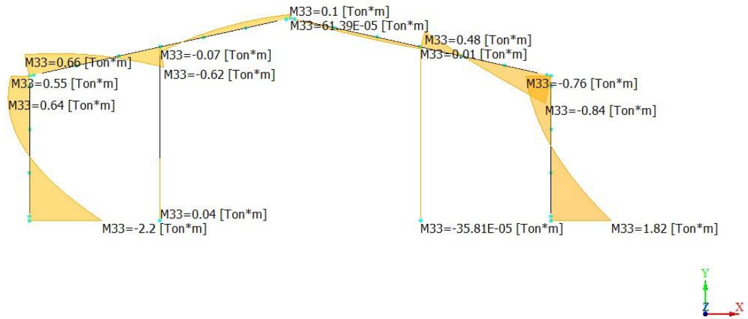
Figura 3.1.2.5 diagrama de momentos para marco exterior.
