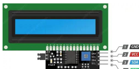
Fig. 3.8 Pinout del módulo I2C LCD. Fuente: Last Minute ENGINEERS.
