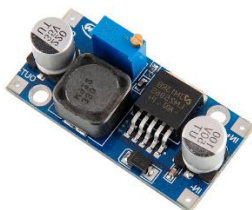
Fig. 3.14 Módulo step-down LM2596. Fuente: Altronics.
