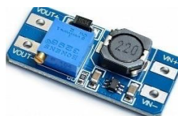
Fig. 3.15 Convertidor boost step-up MT3608. Fuente: MechatronicStore.
