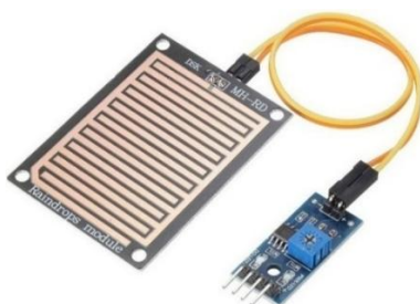
Fig. 3.5 Sensor de lluvia YL-83 FC-37 y Chip Comparador LM393.
