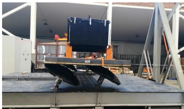
Figura 6: Vista lateral derecha Ensayo pull-back
