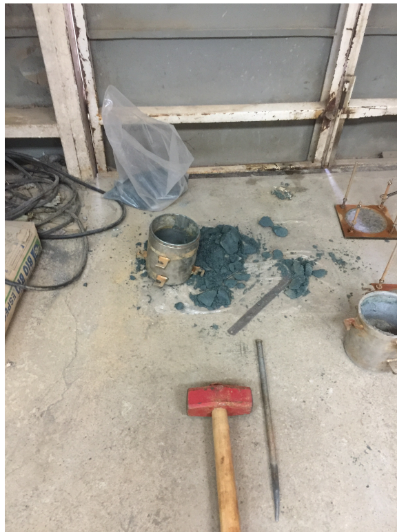
Figura 14. Desmolde del material al finalizar el ensayo de expansión potencial.
