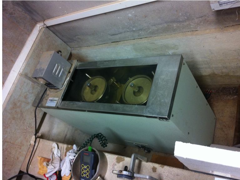
Figura 9. Recipiente para ensayo de expansión potencial.
