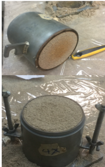
Figura 8. Probetas enrasadas para ensayo Proctor modificado.
