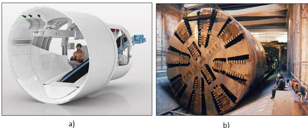
Figura 7: Tipo de tuneladoras escudo: a) frente abierto; b) frente cerrado
