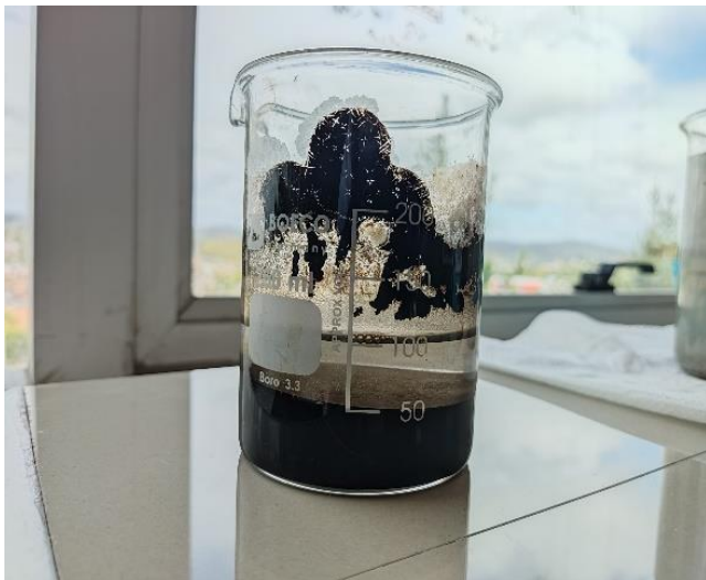
Figura 1. Solución Acuosa con nanopartículas de magnetita. Fuente: Elaboración propia.
