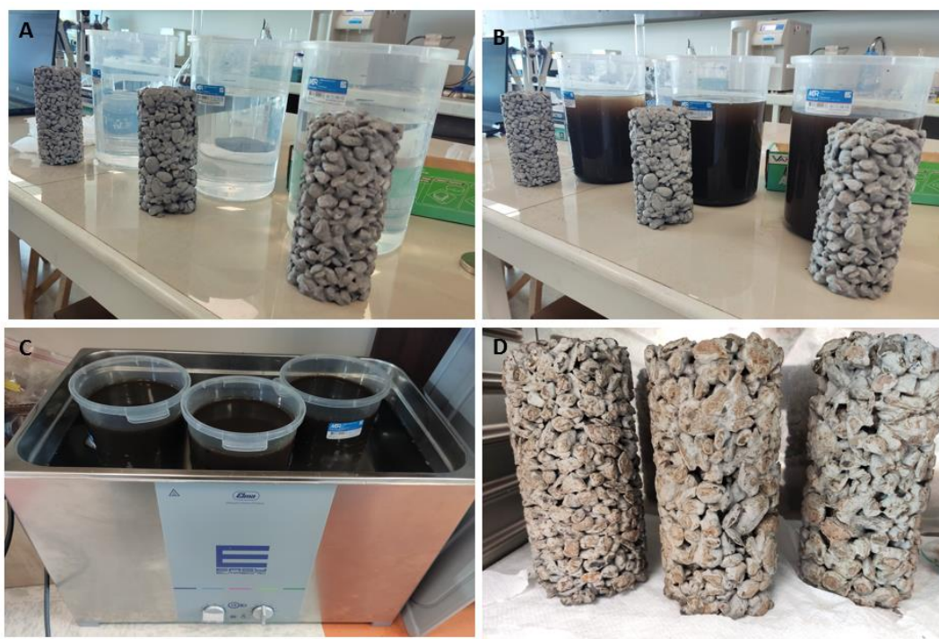
Figura 17: Procedimiento del bañado de Fe_3O_4 en las probetas.
