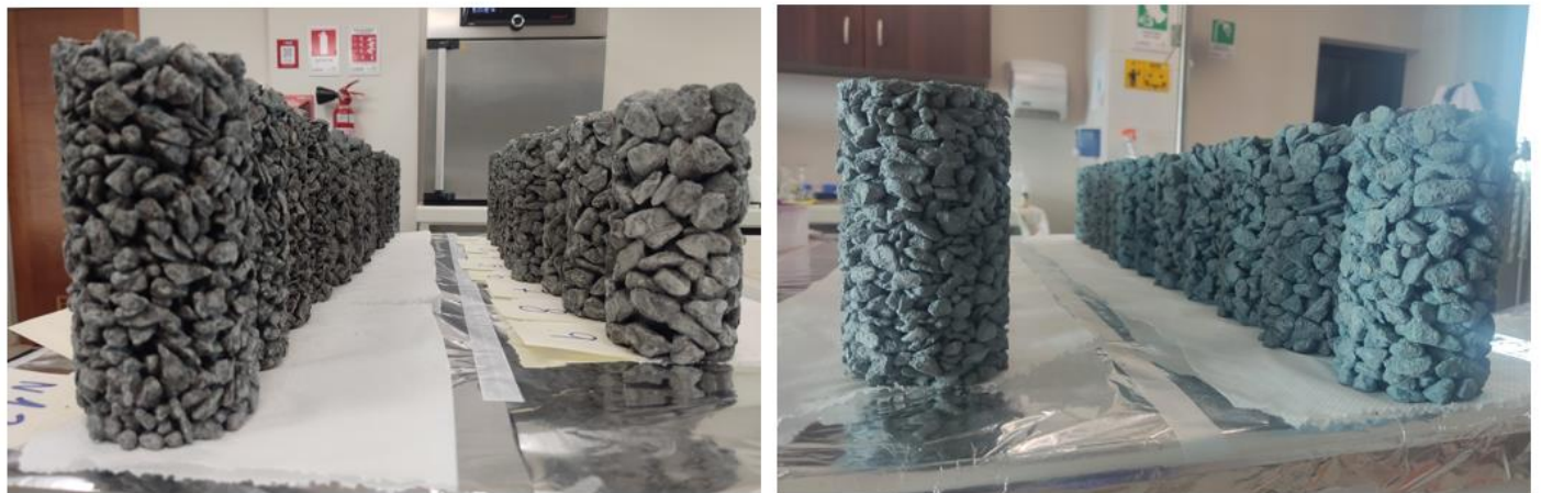
Figura 16: Probetas de hormigón permeable antes y después del ensayo de remoción de contaminantes.
