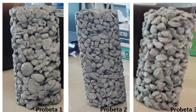
Figura 18: Procedimiento del bañado de Fe_3O_4 en las probetas.
