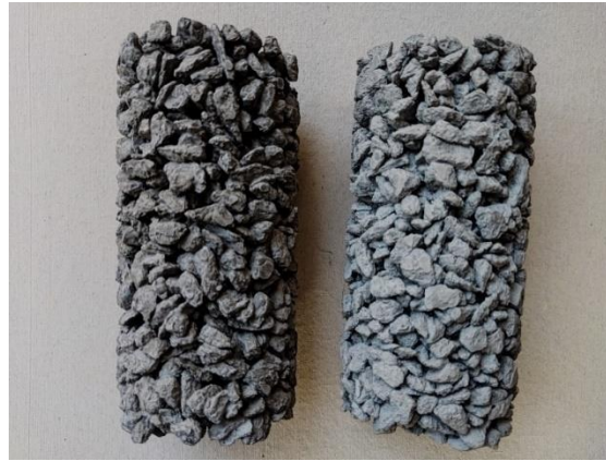
Figura 9: Probetas de tamaño 4.75 mm. La probeta de la izquierda contiene Fe_3O_4 . Fuente: Elaboración propia.
