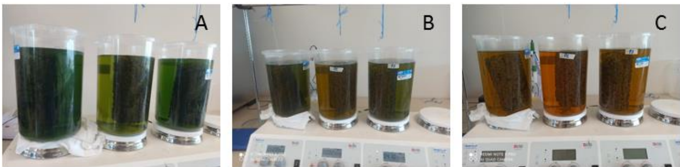
Figura 19: Cambio visual durante el ensayo de adsorción en probetas bañadas en \text{Fe}_3\text{O}_4 .
