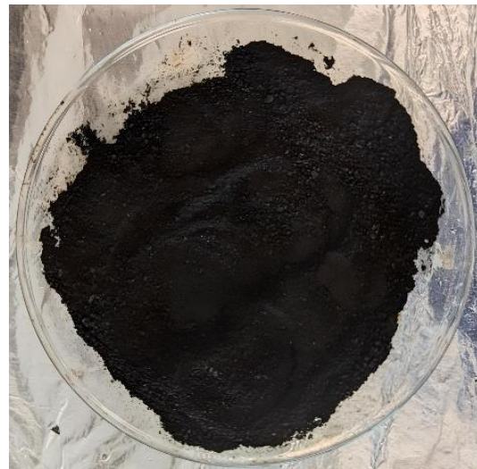
Figura 2. 22 g de nanopartículas de magnetita en estado sólido. Fuente: Elaboración propia.
