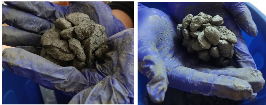
Figura 3. Aspecto físico de la mezcla con el contenido de agua óptimo. Fuente: Elaboración propia.
