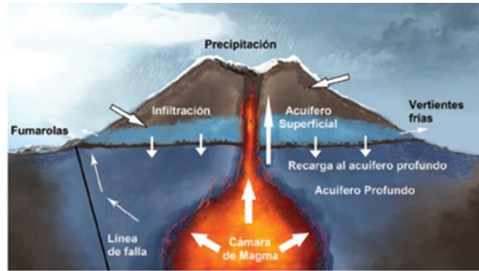
Figura 11: Esquema conceptual del probable sistema acuífero existente en el Volcán Chillán. Adaptado de Peiffer et al., (2011) en Arumí et al., (2012).
