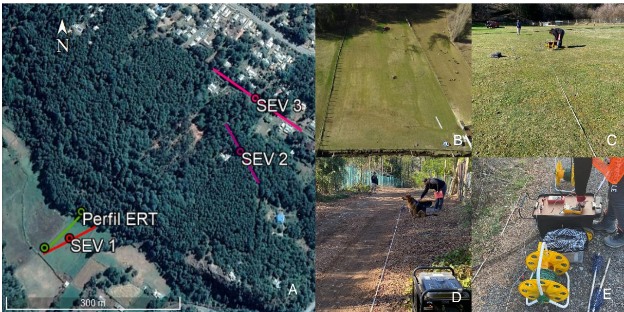
Figura 15: A. Ubicación de los perfiles SEV y ERT (Obtenida de Google Earth); B. Fotografía aérea en zona de estudio para ERT y SEV 1; C. Trabajo en terreno ERT y SEV 1; D. Trabajo en terreno para medición de perfil SEV 2; E. Equipo utilizado mediciones geoelectricas.
