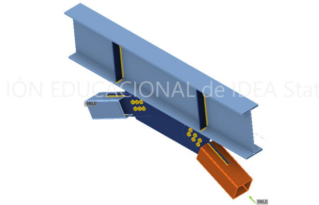
Figura 17. Conexión 4 ya importada a Idea con las características de diseño solicitadas Fuente: Elaboración propia.
