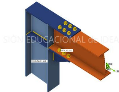
Figura 8. Conexión 1 ya importada a Idea con las características de diseño solicitadas Fuente: Elaboración propia.
