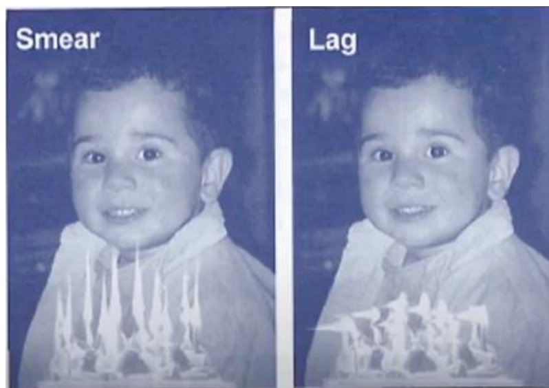
Fig.2.1.3: Efecto “Smear” y “Lag” [17].
