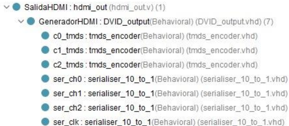
Fig.3.2.16: Módulo “salida: hdmi_out” para visualización en monitor por medio de HDMI.
