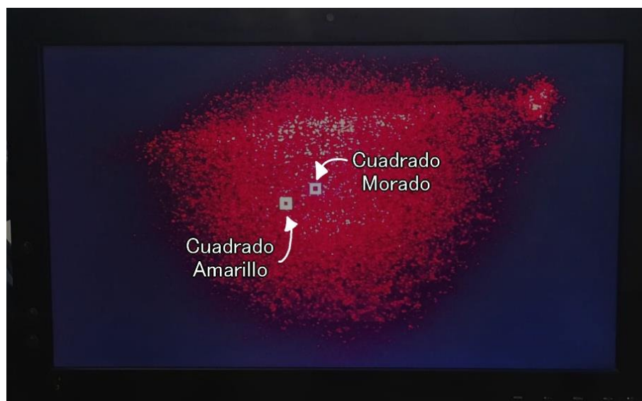
Fig.3.2.12: Monitor con dos cuadrados de referencia para estudio de píxel.
