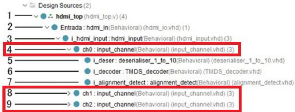
Fig.3.2.8: Módulos input_channel y sus elementos.
