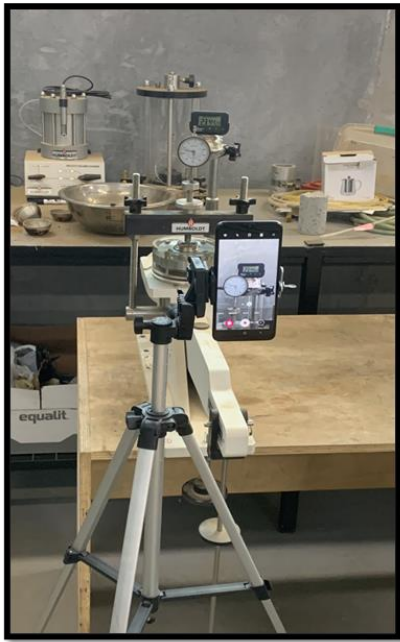
Figura 14: Proceso de adquisición de mediciones de asentamiento a lo largo del tiempo en el laboratorio.
