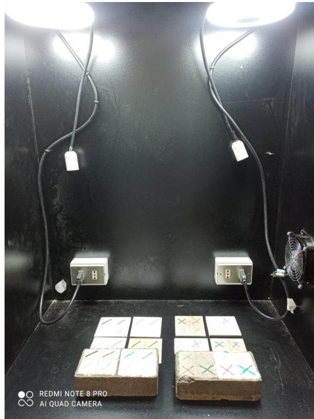
Figura A-10. Ambiente cerrado con las probetas rayadas y radiación visible.
