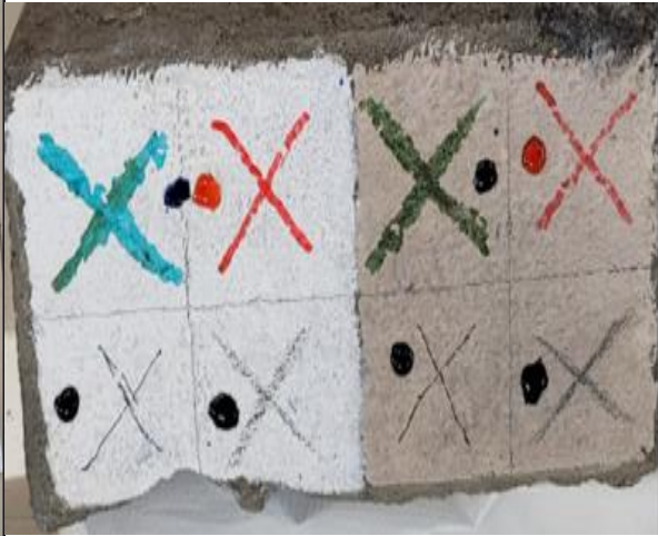
Figura A-12. Probetas de adocreto con tintes.
