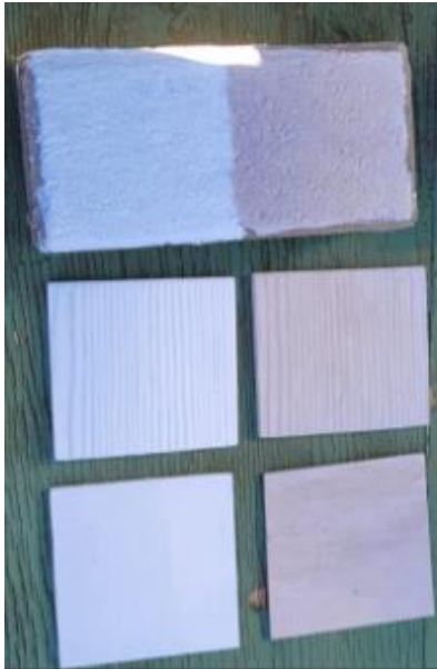
Figura A-4. Probetas dejadas en zona costera.
