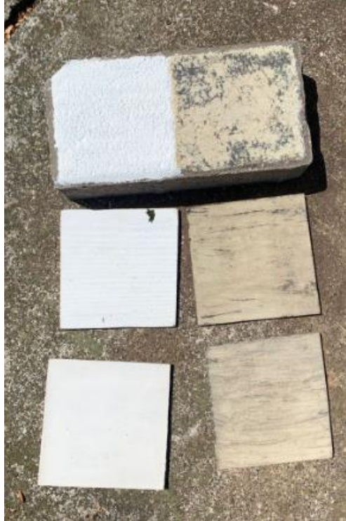
Figura A-6. Probetas dejadas en zona cordillerana San Fabian de Alico.
