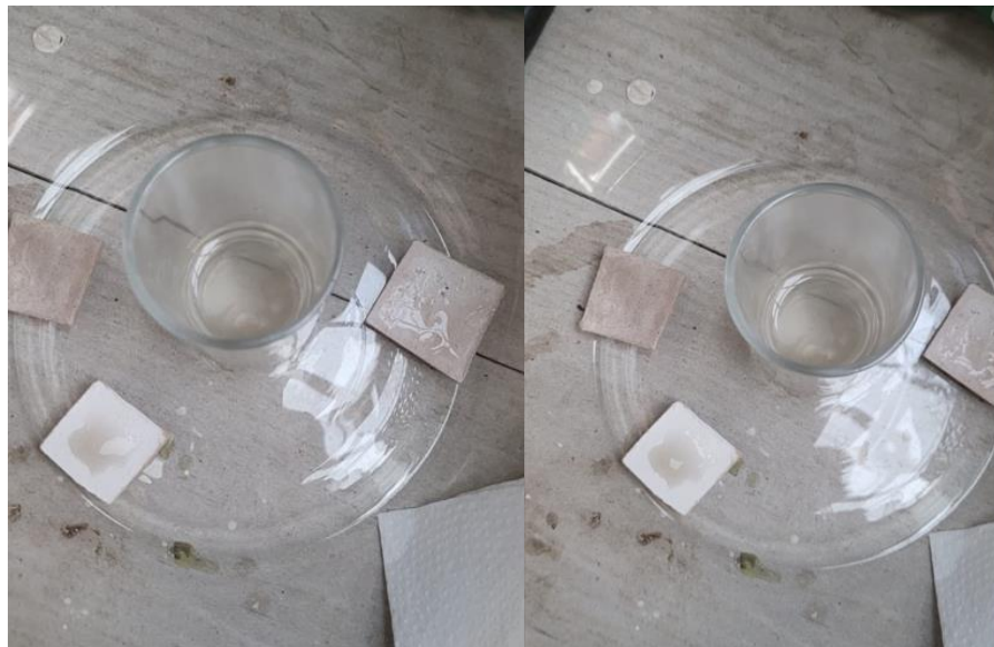
Figura A-16. Probetas con una gota de agua con hongos. Figura A-16.1. Probetas con una gota de agua con hongos.
