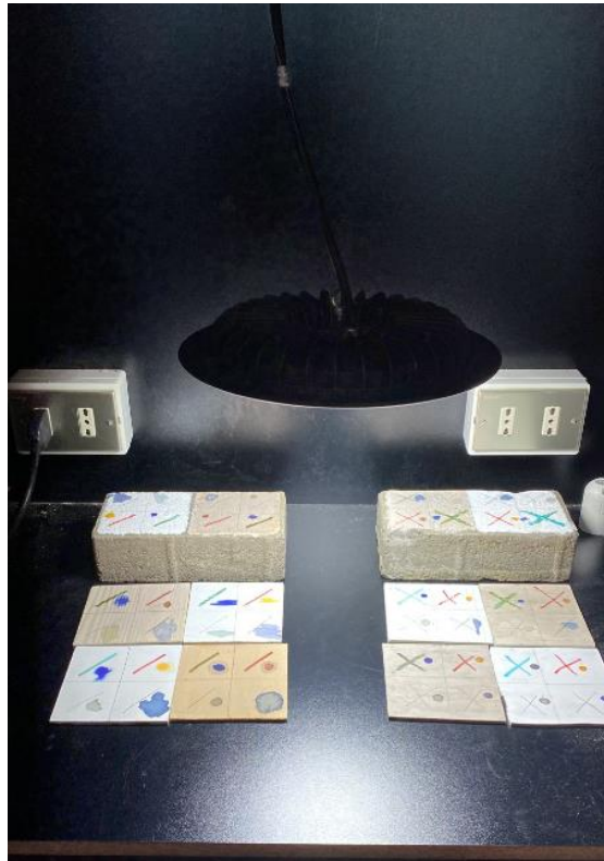
Figura A-13. Ambiente cerrado con las probetas con tintes.
