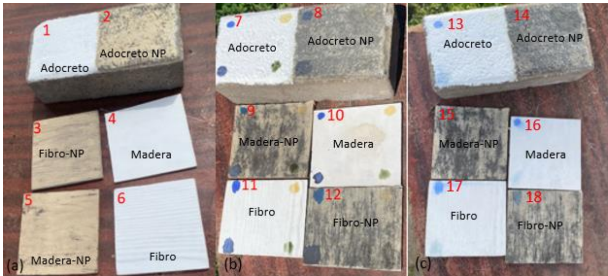
Figura 11. (a) Probetas en zona cordillerana San Carlos día n°1, (b) Probetas en zona cordillerana San Carlos día n°19, (c) Probetas en zona cordillerana San Carlos día n°30. Donde las probetas que no dicen NP es debido a que en la pintura no tienen NP- \text{Ag}_6\text{Si}_2\text{O}_7 y las que tienen NP la pintura si tiene NP- \text{Ag}_6\text{Si}_2\text{O}_7 .
