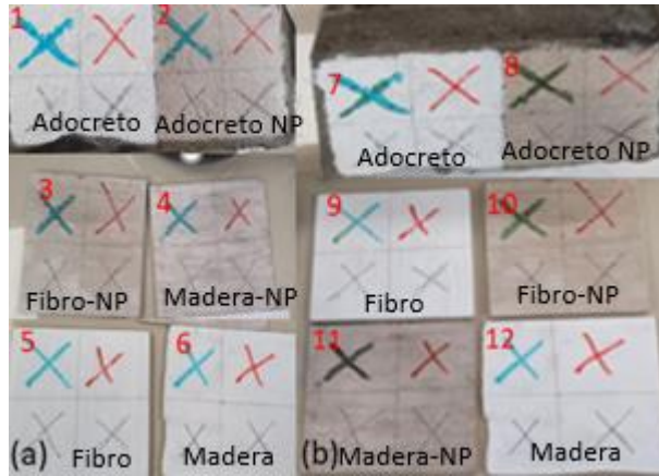
Figura 13. (a) Probetas rayadas antes de dejarlas en la cámara oscura con luz blanca, (b) Probetas rayadas luego de la aplicación de radiación mediante un foco led. Donde las probetas que no dicen NP es debido a que en la pintura no tienen NP-Ag 6 Si 2 O 7 y las que tienen NP la pintura si tiene NP-Ag 6 Si 2 O 7 .
