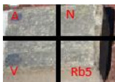
Figura 3. Distribución de los tintes, A (azul de metileno), N (naranja de metileno), V (Violeta de pyrocateolo), Rb5 (Reactive black 5).
