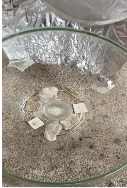
Figura A-17. Ambiente cerrado agregando mondadientes y algodones con hongos.
