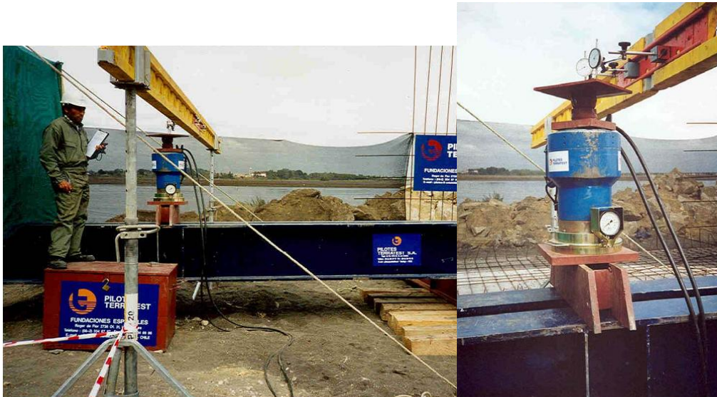
Figura II.18 Estructura de ensayo de carga a tracción, detalle de ubicación de diales comparadores y celda de carga en gato hidráulico (Documento Terratest, 2006)
