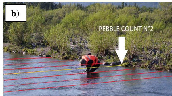
Figura 2. 8: a) Ubicación espacial de las granulometrías tomadas en terreno. b) Ejecución en terreno del método de Wolman (1954). Fuente: Elaboración propia.
