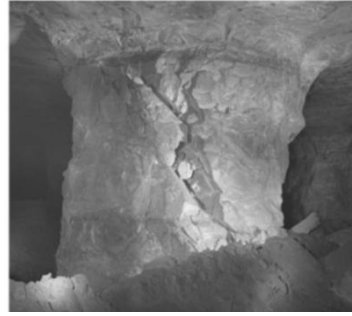
Figura 3: Pilar que falló a lo largo de dos discontinuidades angulares (Esterhuizen et al., 2008).
