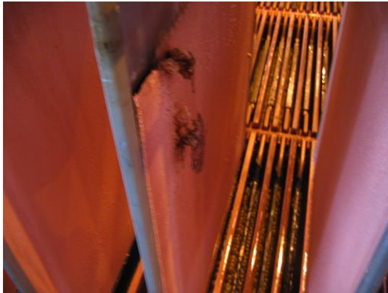
Fig 5: Corto circuito en cátodo
