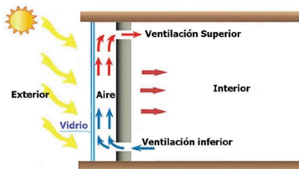
Figura 3: Descripción muro Trombe ventilado.
