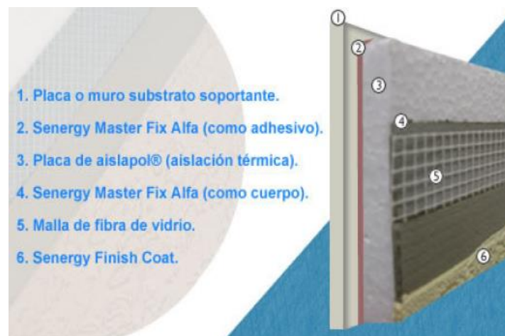
Figura 6. Esquema composición revestimiento exterior o sistema EIFS.
