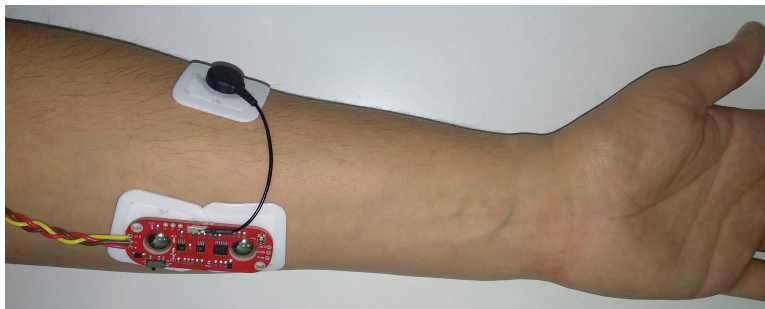
Figura 2.1: Sensor Electromiográfico posicionado sobre musculo.
