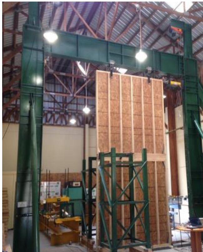
Figura 4.6: Muro 2.44m x 5.02m y Marco de carga utilizado. Fuente: LME-INFOR.
