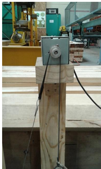
Figura 4.9. Transductor de posición tipo Encoder. Fuente: LME-INFOR.
