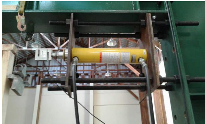
Figura 4.8: Cilindro de doble efecto y celda de carga. Fuente: LME-INFOR.
