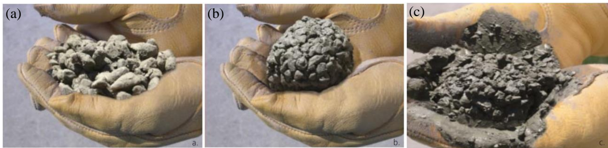
Figura 5. Muestras de hormigón permeable con diferentes contenidos de agua, formando una bola. (a) Muy poca agua. (b) Cantidad adecuada de agua. (c) Demasiada agua. (Fuente: Tennis et al. , 2004)
