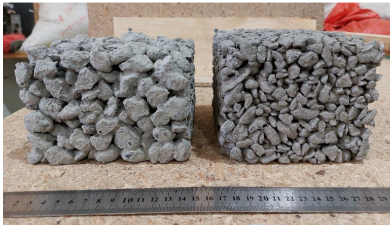
Figura 10. Comparación de bloques de hormigón permeable con árido promedio de 30 mm (izquierda) y con árido entre 4,75 mm y 12,5 mm (derecha).
