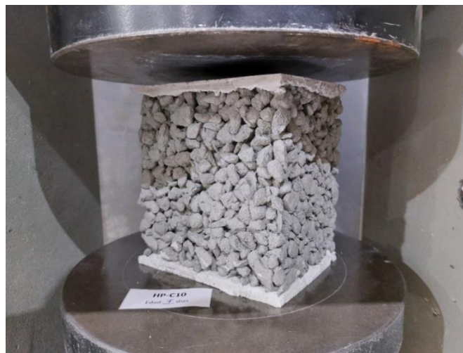
Figura 7. Bloque de mezcla HP-C10 refrentado en sus dos caras, en máquina de ensayo a compresión antes de ejecutar el ensayo.
