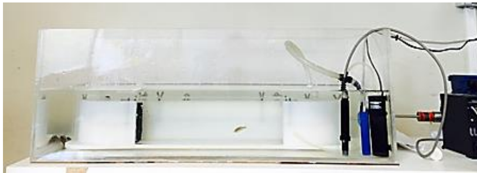
Fig. 15. Medición de la velocidad crítica de un ejemplar de C. galusdae . Fuente: Elaboración propia.
