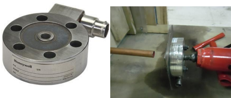
Figura 3.9. a) Celda de carga Honeywell modelo 41 b) Celda de carga montada a la gata.
