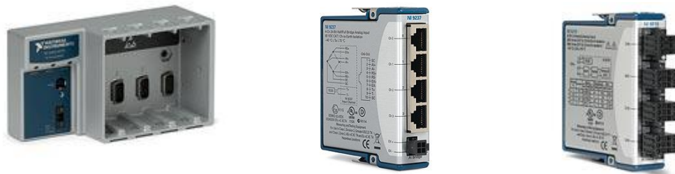
Figura 3.8. a) NI cDAQ-9174 b) NI 9237 c) NI9235.
