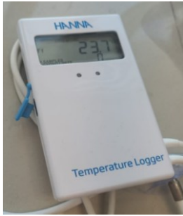
Imagen N°15: Sensor Temperatura Fuente: Elaboración propia
