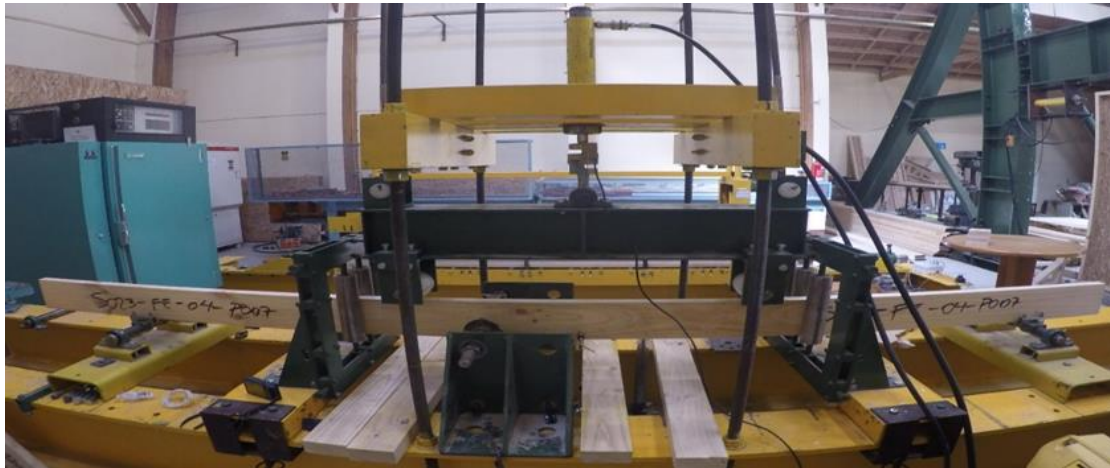
Figura 3: Ensayo de flexión laminación vertical. Fuente: Elaboración propia.
