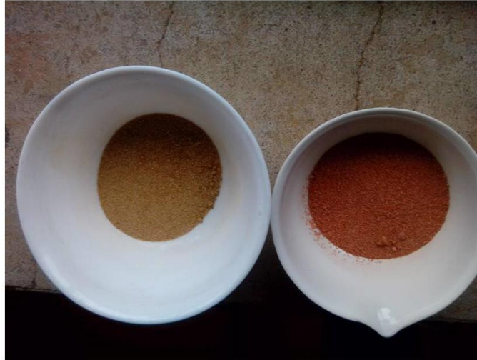
Figura 3.25 Material sin calcinar (izquierda), material calcinado (derecha).
