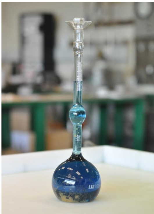
Figura 3.23 Ensayo para determinar densidad aparente con querosén.
