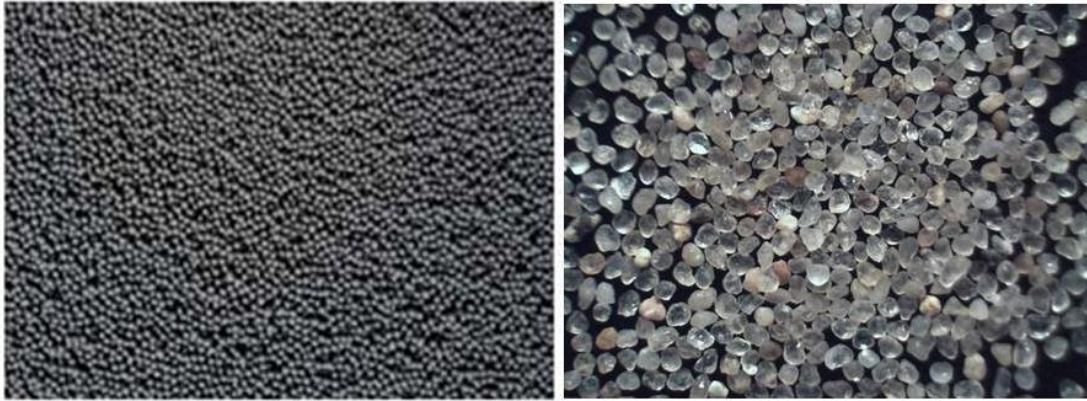
Figura 2.4: A la izquierda se muestra un material de soporte cerámico (GDG CERAMIC), y a la derecha se encuentra la imagen de un material de soporte de sílice natural (South Dakota Proppants, LLC). Las imágenes no se encuentran a la misma escala.
