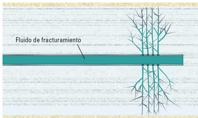
Figura 2.2 Fracturamiento hidráulico. (Kraemer, et al, 2014).
