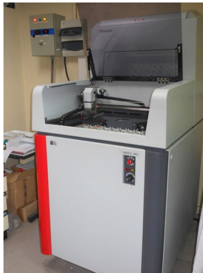
Figura 3.38 Equipo Bruker D4 Endeavor utilizado para determinar la concentración de los componentes del material, GEA Universidad de Concepción.
