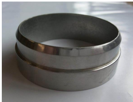
Figura 3.29 Celda utilizada para medir permeabilidad.
