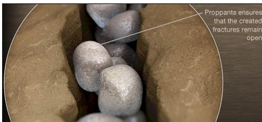
Figura 1.3 Material de soporte posicionado en la fractura ( Smith et al., 2011 ).
