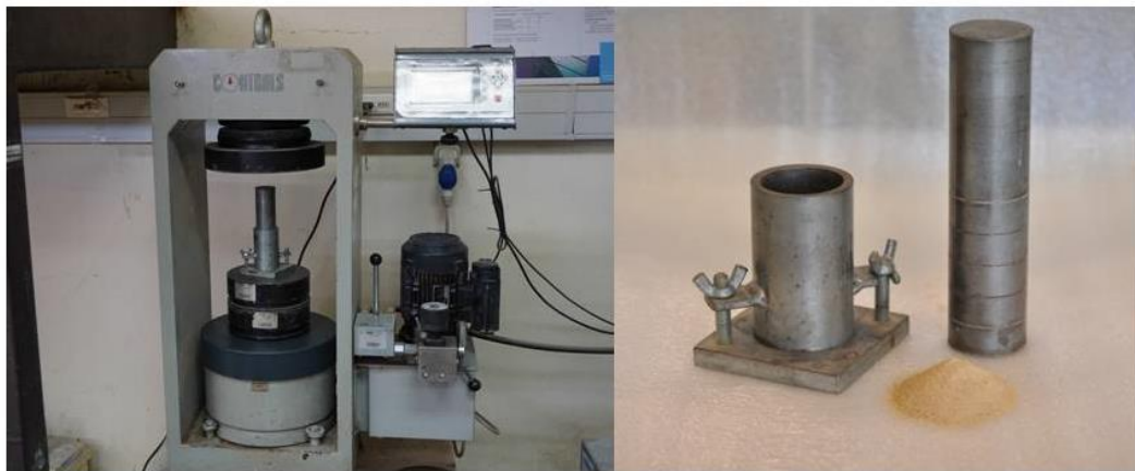
Figura 3.26 Materiales ensayo resistencia a la fracturación. Laboratorio de Geomateriales UCSC.
