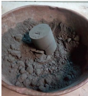
Figura 6. Probeta ensayada del Proctor modificado
