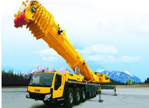
Figura 4 Grúa sobre camión QY200.
