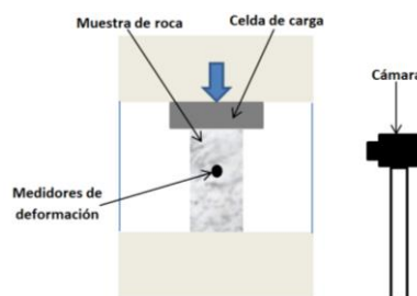
Figura 6: Esquema de la preparación de la técnica de seguimiento por video aplicado a ensayos de roca (Bravo-Haro, 2017).
