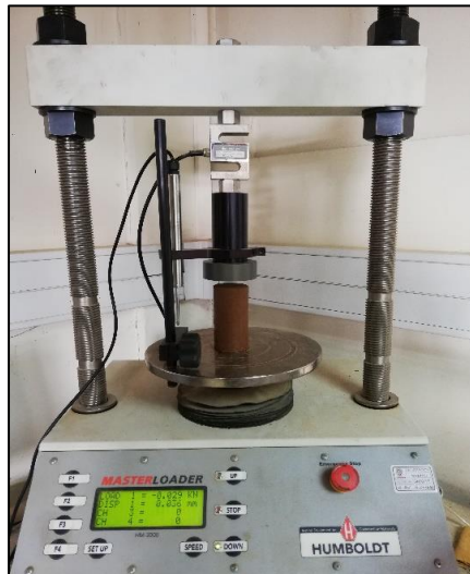
Figura 6: Equipo multiaxial Humboldt Máster Loader HM-3000.3F Fuente: Elaboración Propia.
