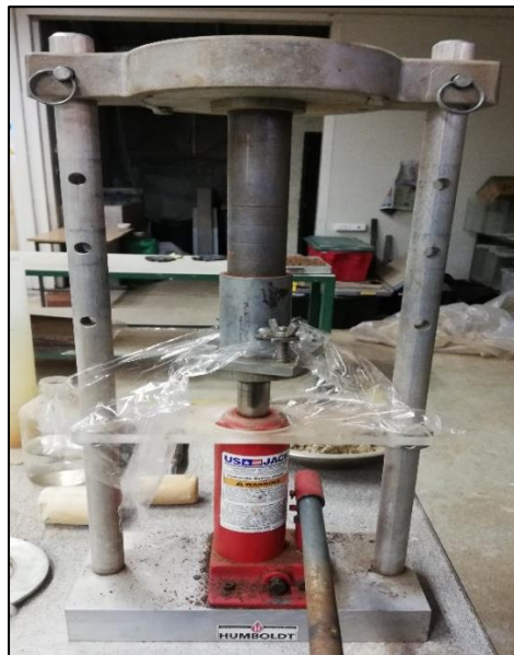
Figura 10: Gato hidráulico empleado en la compactación de las probetas de compresión simple Fuente: Elaboración Propia.
