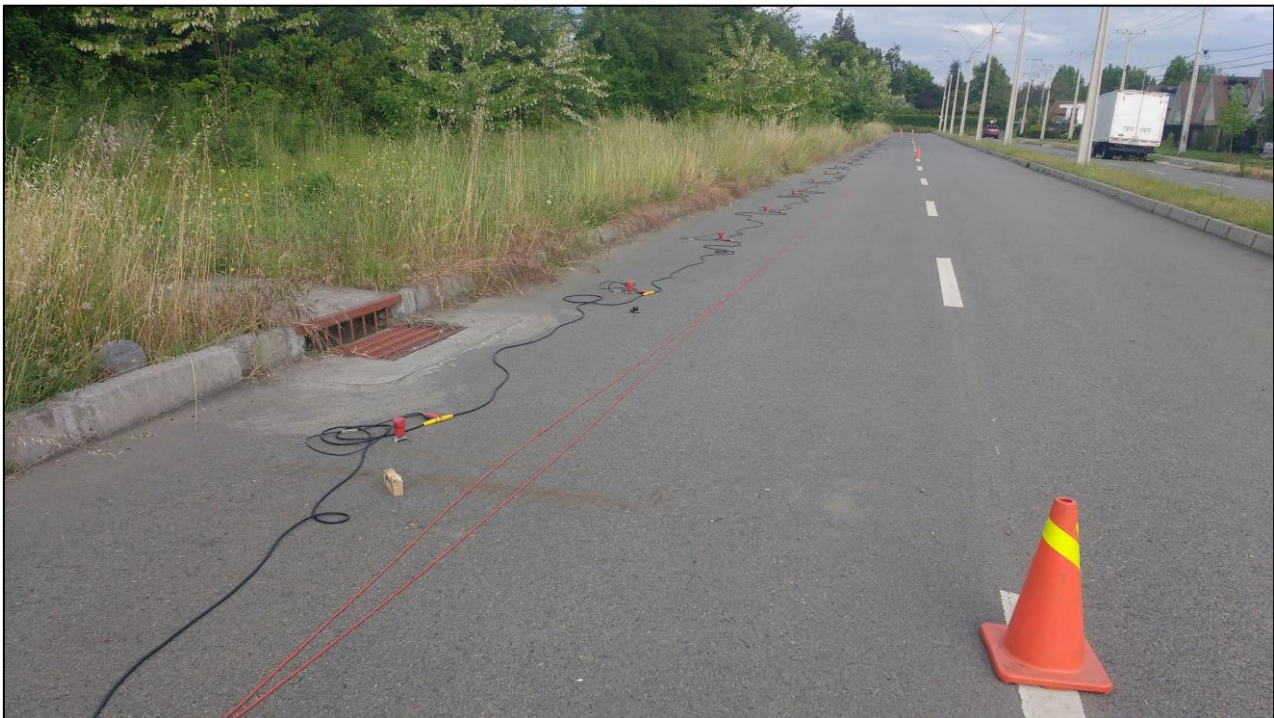
Figura 9: Distribución de los geófonos en terreno, espaciados cada 4 metros.
