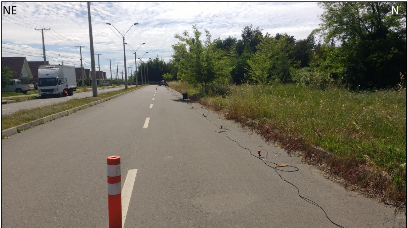
Figura 2: Distribución de la línea de geófonos dentro del pavimento de la zona de estudio. Vista noreste-norte. Ubicado en UTM 18H 761974.00 m E, 5947430.00
