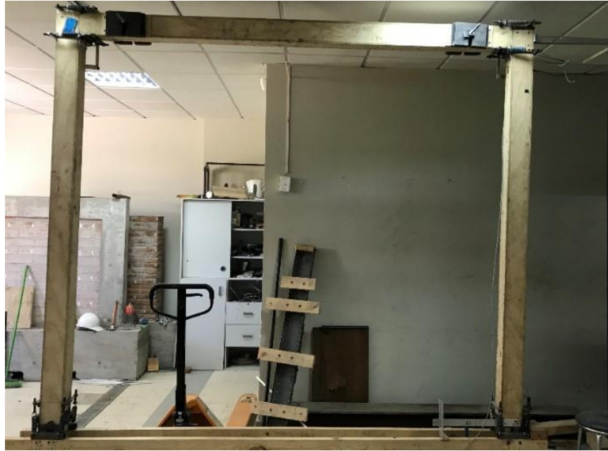
FIGURA 8: MODELO ESTRUCTURAL INSTALADO CON SISTEMA DE VIBRACIÓN LIBRE
