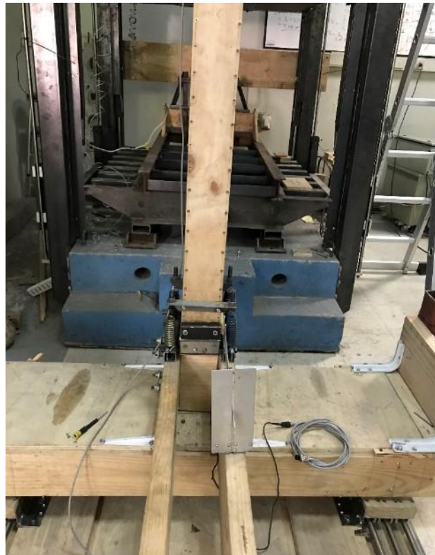
FIGURA 4: BASE DEL MARCO DE CARGA SOBRE RIELES EMPOTRADO.
