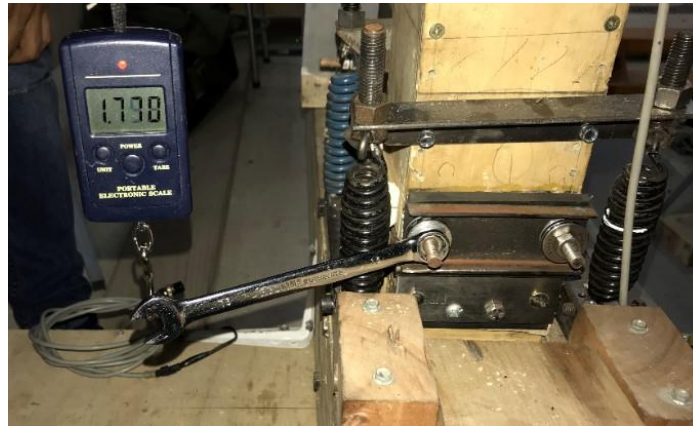
FIGURA 6: FORMA DE ENTREGAR CARGA NORMAL A LA COMPONENTE DE ROCE
