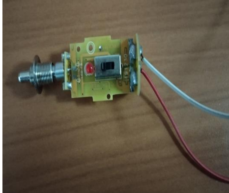
Fig 32. Diodo láser desarmado con dos cables jumper para alimentación.
