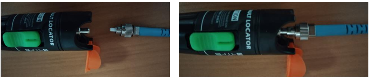
Fig 31. Ejemplo de diodo láser y fibra óptica antes y después de la conexión.
