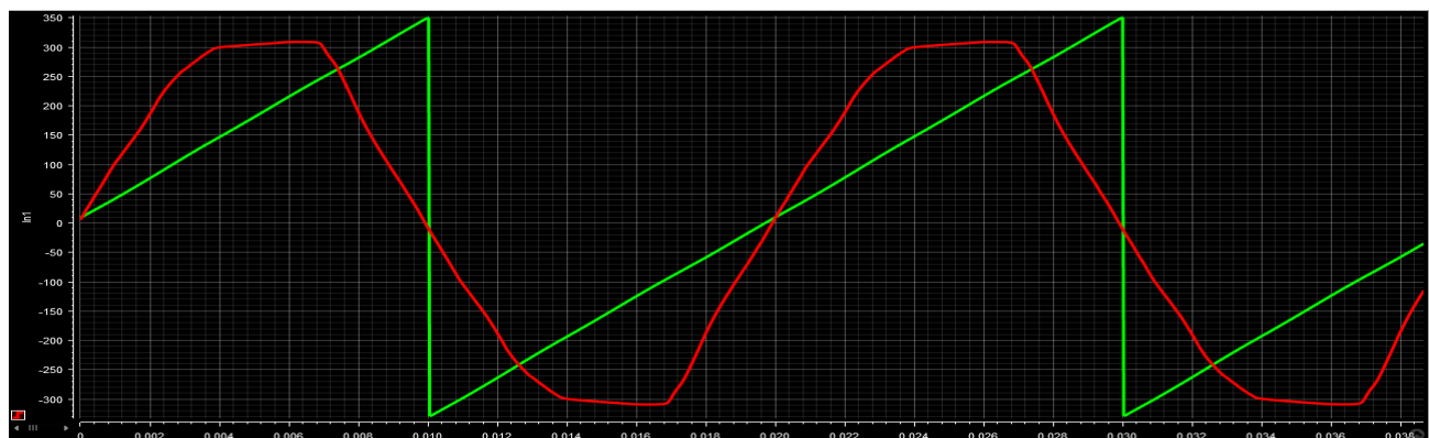
Fig. 11.3 Ángulo de la PLL obtenida a través del Control Desk dSPACE
