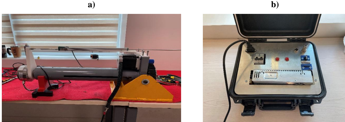
Figura 11: a) Actuador implementado en la UCSC, con su respectivo sensor LVDT y celda de carga. b) Maleta de control del actuador.
