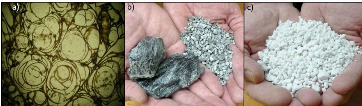
Figura 2.1: Material a distintas escalas donde: (a) Textura perlítica en “capas de cebolla” concéntricas y microgrietas (1,8 mm), (b) perlita en forma de roca y triturada y (c) perlita Expandida. Extraído de Perlite Institute (2009); Rotella y Simandl (2010).
