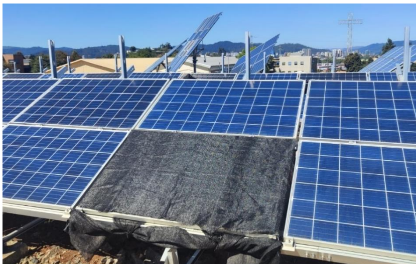
Figura 3.5: Sombreado de manera experimental de paneles fotovoltaicos
