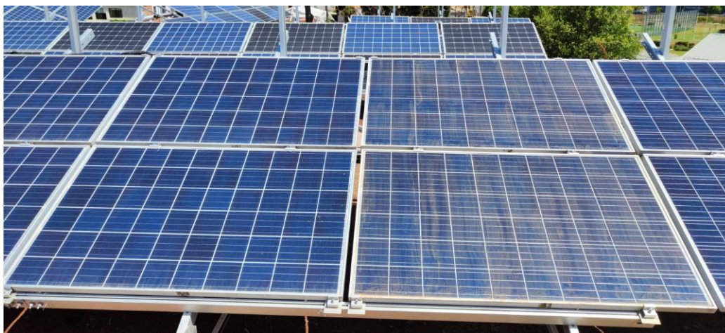
Figura 3.24 Muestra la comparación entre un panel limpio y otro ensuciado intencionalmente
