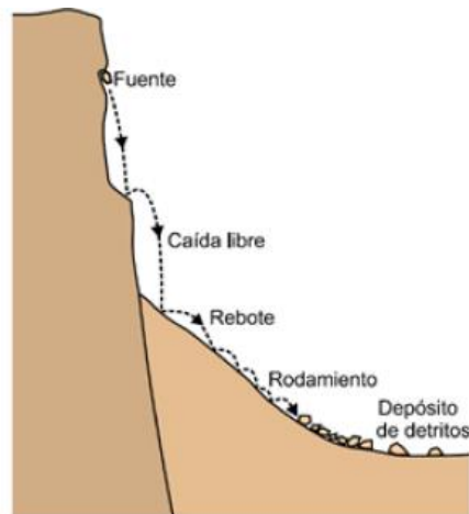
Figura 3: Esquema caída de rocas (Proyecto Multinacional Andino, 2007)
