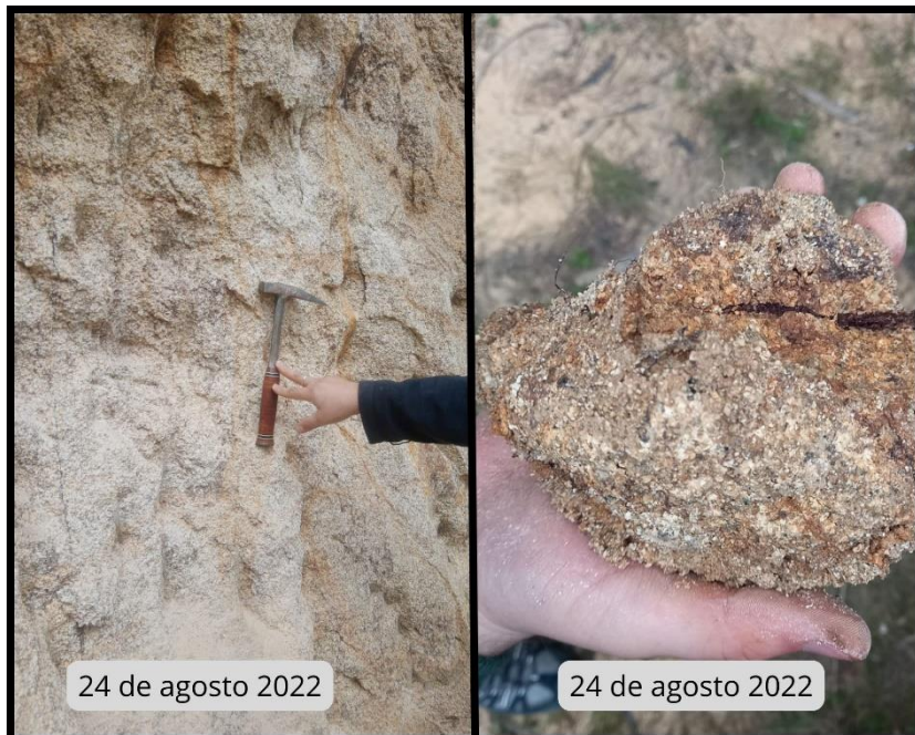
Figura 13: Grado de meteorización. Presencia de maicillo de (Gentileza de Miguel Abarzúa, Sebastián Antinao & Gonzalo Peña, 2022)
