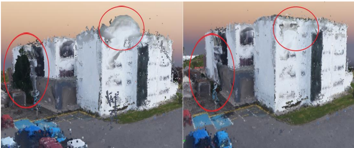
Figura n° 12. Imagen representando el antes y después de aplicar correcciones en la nube de puntos.
