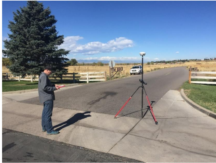
Figura n° 4. Ejemplo medición de puntos de control (Fuente: Compassdata).
