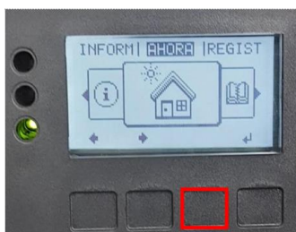
a.-Se presiona 5 veces el boton señalado.
