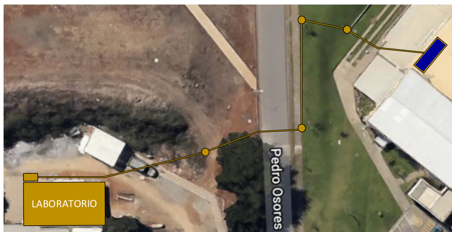
Figura 2.4 Canalización y Cámara subterránea
