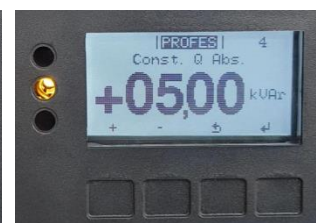
B.2.4.- Se elige la cantidad de potencia que se desea inyectar de manera directa.*
