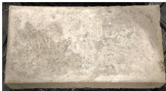
Figura 4: Probeta desmoldada después de 48 horas. Fuente: Elaboración propia.
