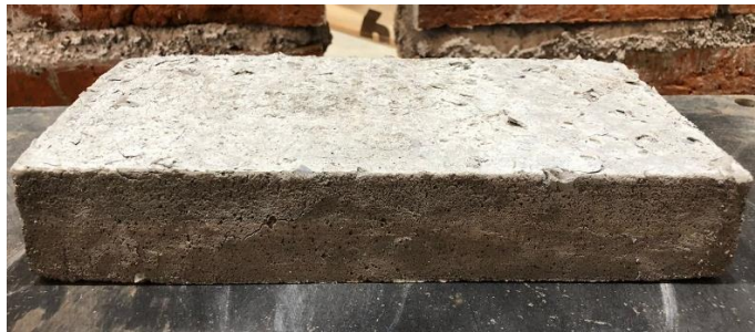
Figura 8: Probeta de hormigón PET (80%/20%). Fuente: Elaboración propia.
