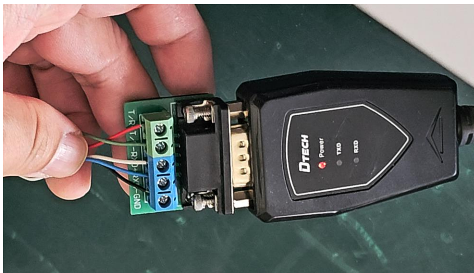
Fig. 4.5 Comunicación RS422-RS232- USB. Fuente: Laboratorio NAOC, China.
