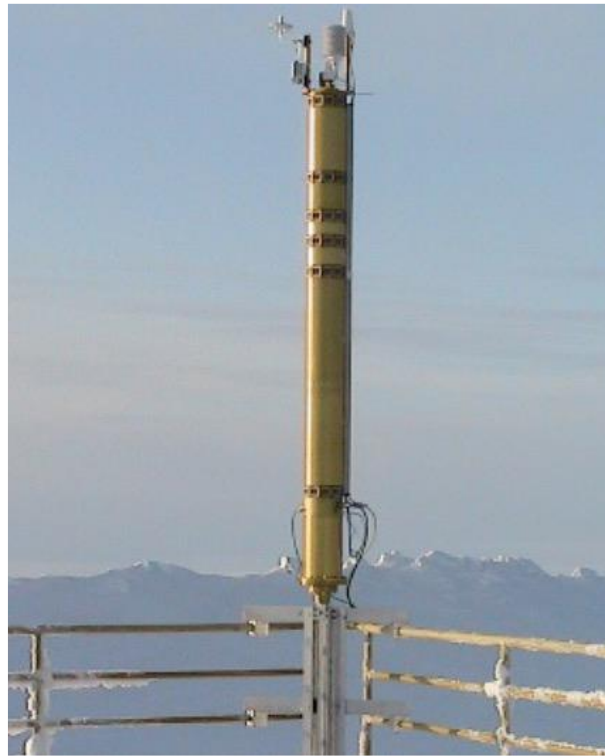
Fig. 2.3 Arctic Turbulence Profiler (ATP). Fuente: Hickson et al (2013).
