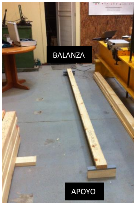
Figura 3.13: Montaje de la probeta en equipo Fakopp.
