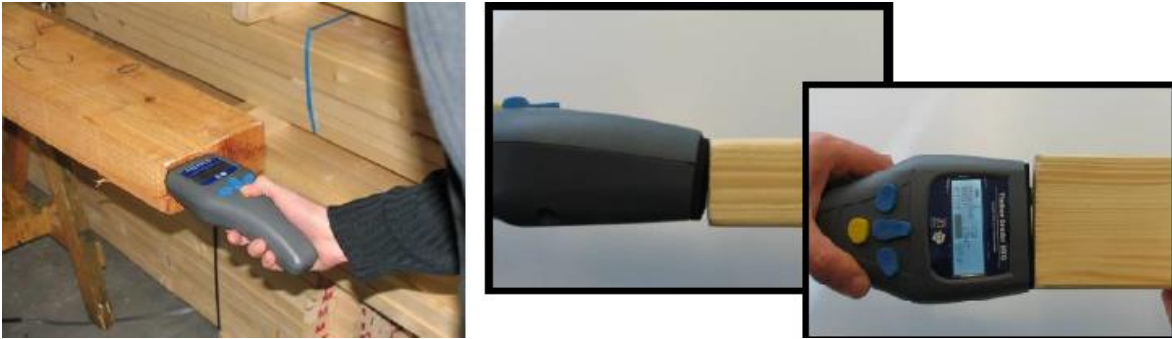
Figura 3.10: Errores en medición con Timber Grader MTG.
