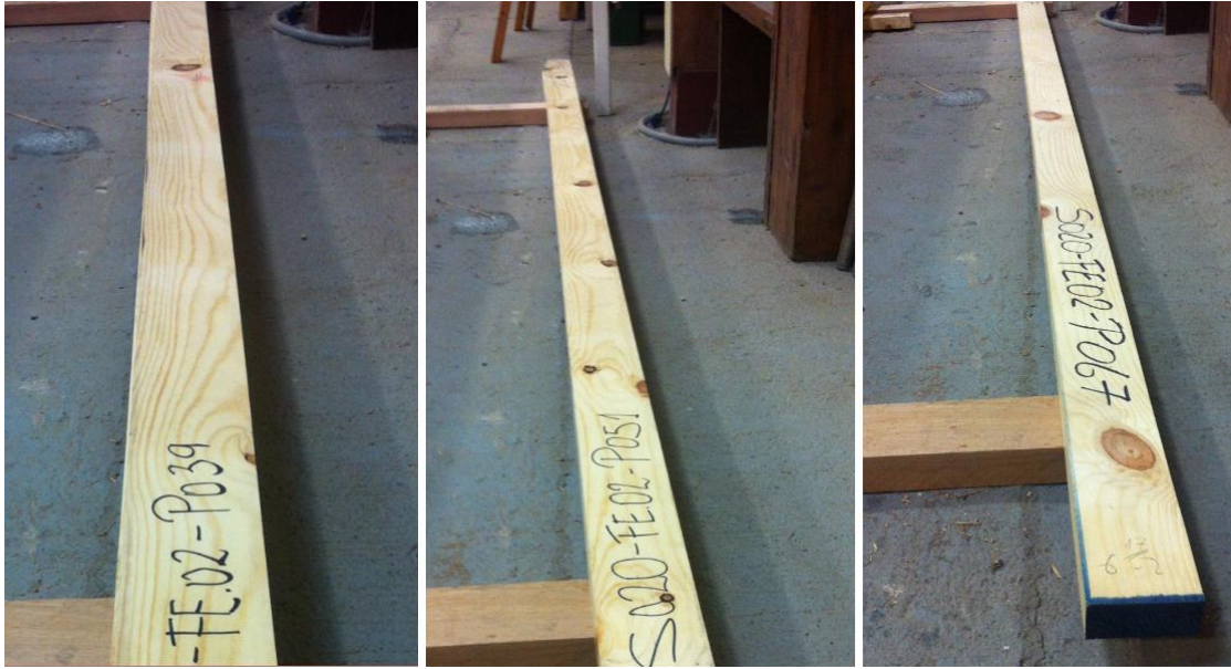
Figura 4.3: Nudos de gran envergadura en probetas de Gr. Estructural G2.
