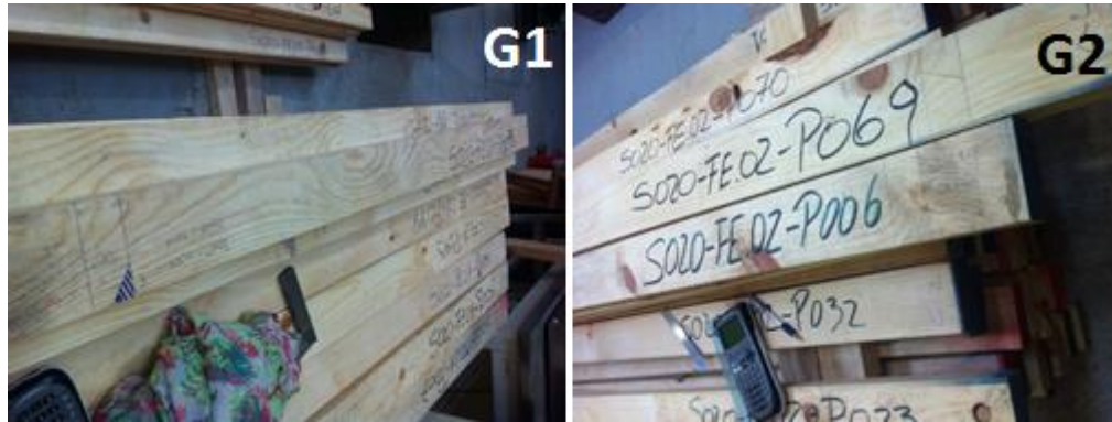
Figura 4.9: Probetas con menor RANT de cada grado estructural
