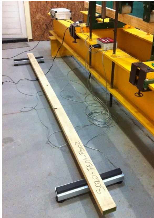
Figura 3.6: Montaje equipo MTG
