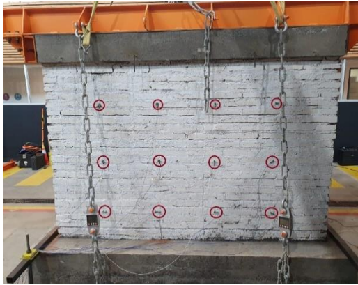
Figura 12: Grilla de 12 acelerómetros en una cara del muro de albañilería (Fuente: Elaboración propia)
