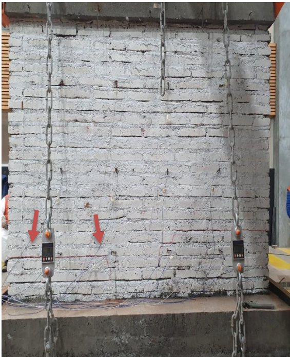
Figura 27: Falla por adherencia en la cuarta fila, en el proceso de contracción del actuador, en el ciclo de 10 (mm) (Fuente: Elaboración propia)
