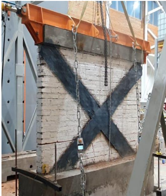
Figura 37: Luego de la falla del refuerzo de CFRP se estabiliza (Fuente: Elaboración propia)
