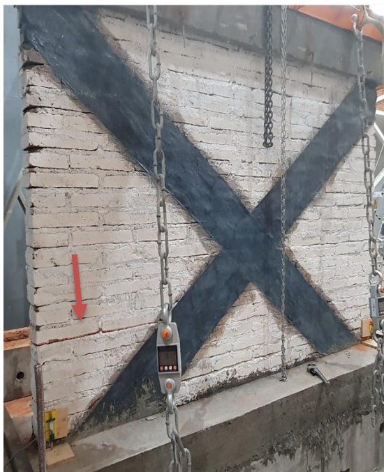
Figura 23: Falla por adherencia en lado izquierdo del muro, vista frontal, sexta fila (Fuente: Elaboración propia)
