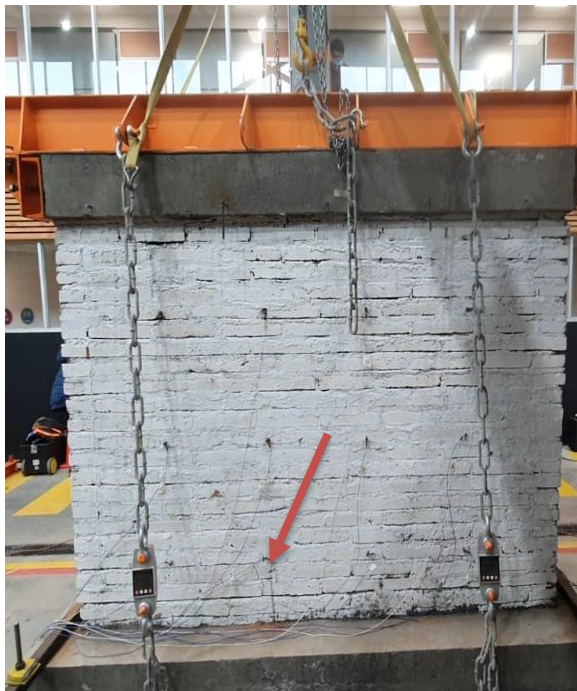
Figura 21: Primera grieta visible en la parte posterior del muro de albañilería (Fuente: Elaboración propia)
