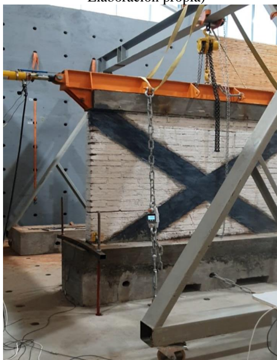
Figura 32: Falla por adherencia en la sexta corrida, momento justo en que se detiene el actuador en el proceso de extensión (Fuente: Elaboración propia)
