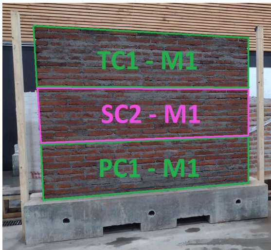
Figura 6: Distribución de preparación de mortero en 3 etapas (Fuente: Elaboración propia)
