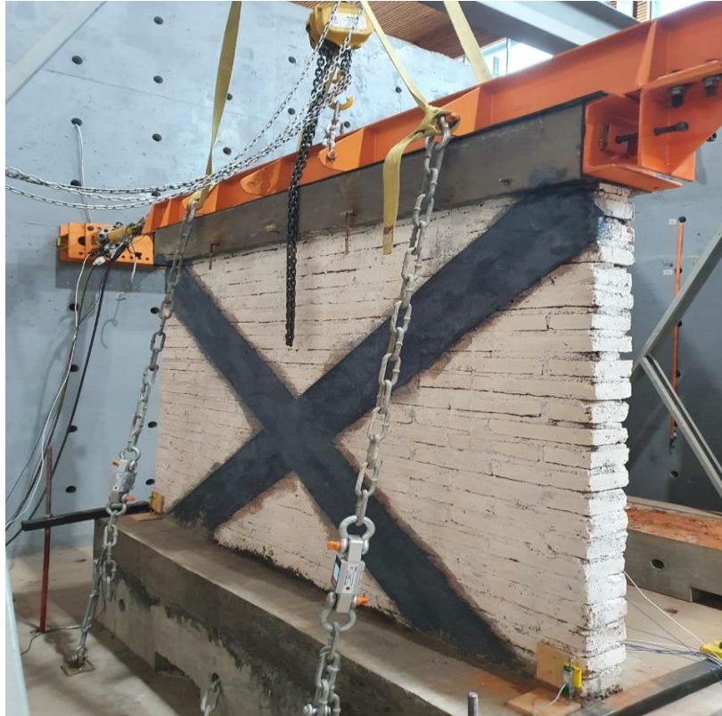
Figura 11: Muro montado para ensayo con aparejo de carga (Fuente: Elaboración propia)
