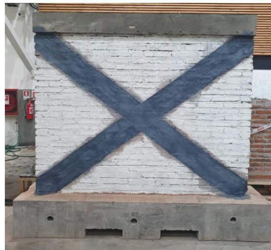
Figura 7: Muro de albañilería simple, con viga de hormigón armado, pintado blanco y reforzado con tiras de CFRP (Fuente: Elaboración propia)
