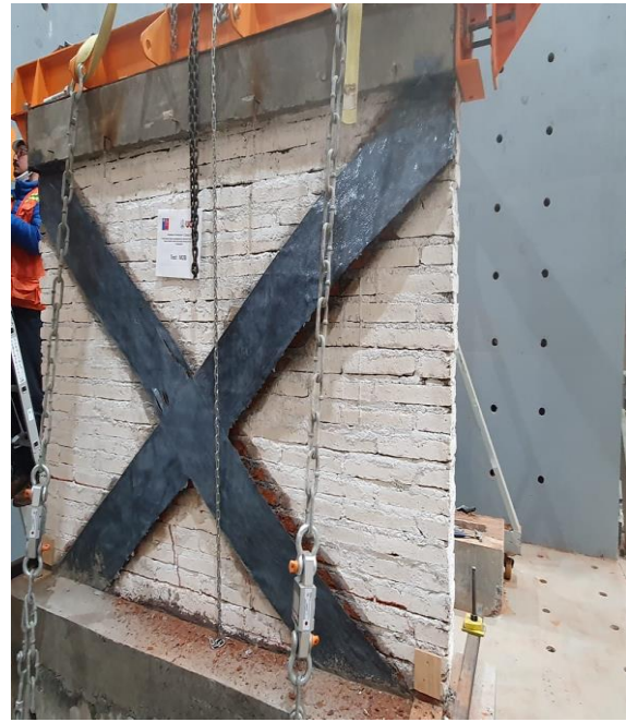
Figura 38: Falla del refuerzo de CFRP, visto desde otra perspectiva (Fuente: Elaboración propia)
