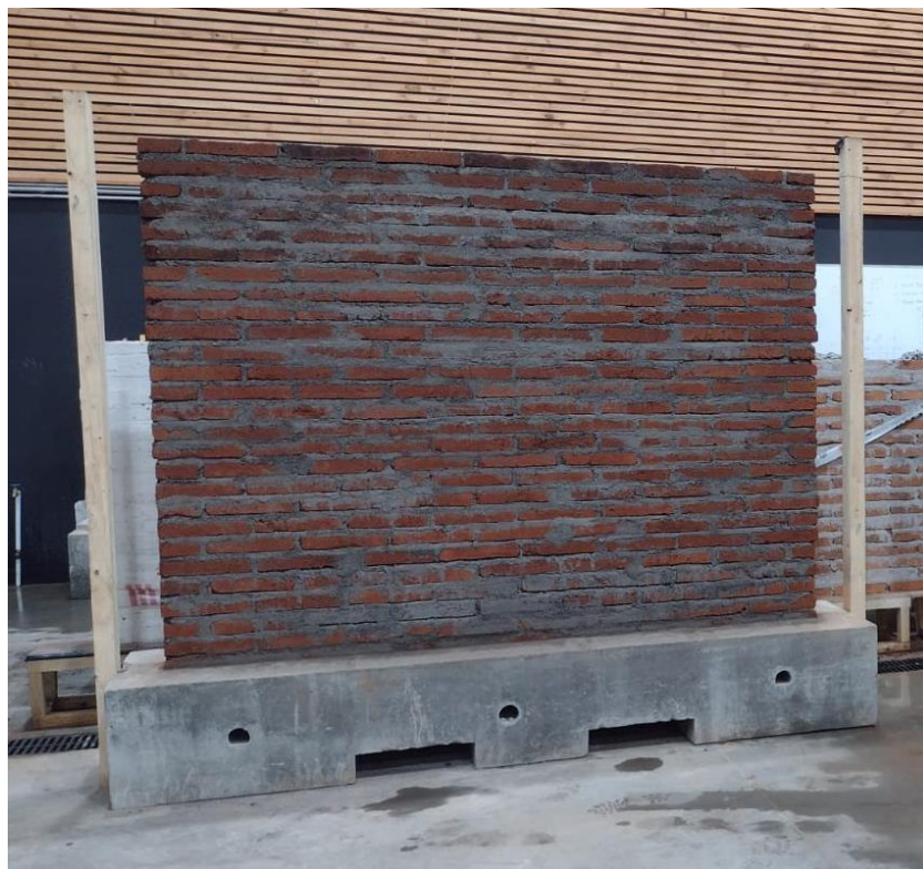
Figura 5: Muro de albañilería simple (Fuente: Elaboración propia)
