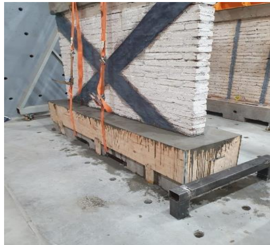
Figura 10: Hormigonado de fundación posterior a reparación (Fuente: Elaboración propia)
