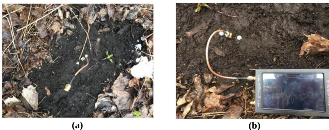
Fig. 2.13 (a) Instrumento enterrado en el suelo para realizar la medición. (b) Medición de las características del suelo con el Nano VNA. Fuente [15]
