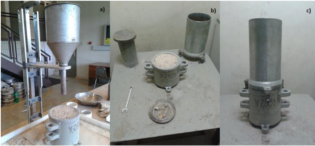
Figura 3.25: a) instalación de muestra para calcular densidad mínima, b) y c) encaje de muestra en mesa vibradora para calcular la densidad máxima.
