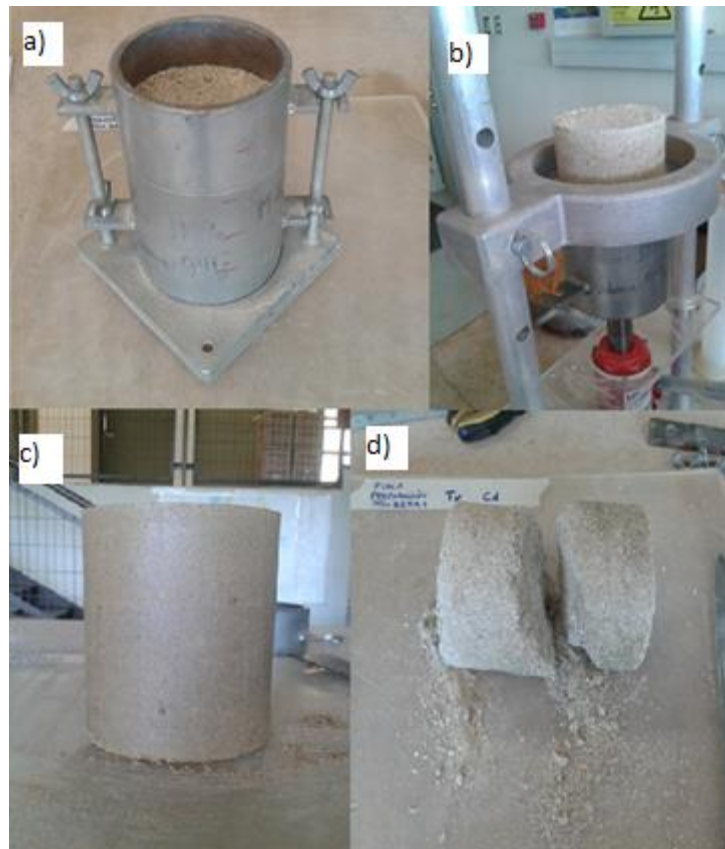
Figura 4.40 a) Molde de 100,16 mm donde se compacto la muestra, b) extracción de muestra con gata, c) probeta y d) Muestras para determinar humedad.
