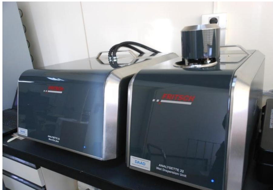
Figura 3.13 Equipo ANALYSETTE 22 MicroTec plus, a la izquierda unidad de medición, a la derecha unidad de dispersión ultrasónica en húmedo.
