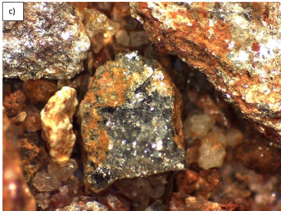
Figura 5.28 a) Es la muestra B.14 original, b) y c) corresponde a la muestra B.14 lavada por malla N° 200 (0,075 mm) y secada en horno a 60° C. Ancho de imagen 3mm
