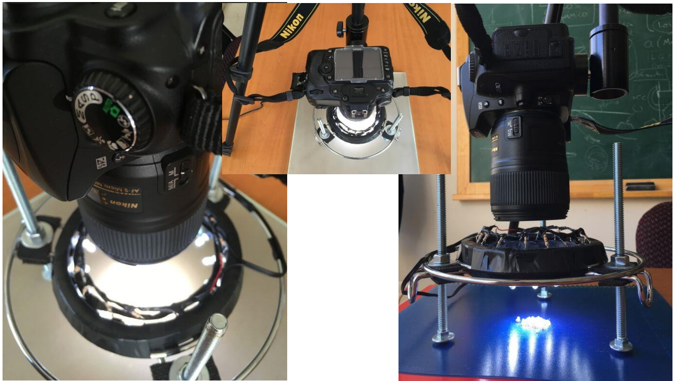
La figura b.1 muestra el montaje de la cámara y luz para toma de fotografías a las muestras
