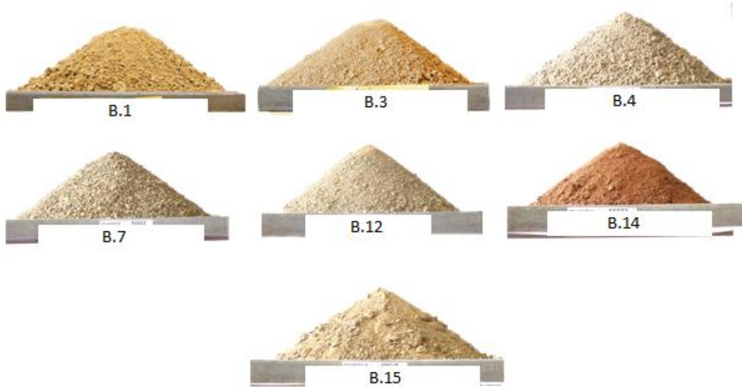
Figura 4.6 Angulo de reposo realizado a las 7 muestras.
