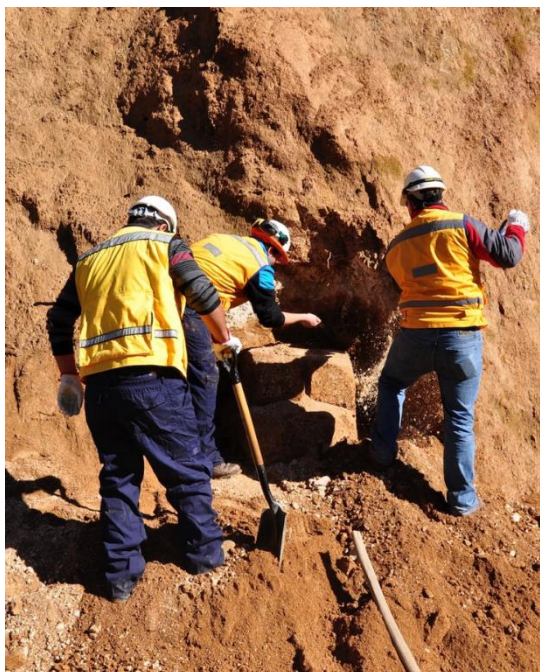
Figura 3.10 Extracción de un bloque inalterado para ensayo de laboratorio.
