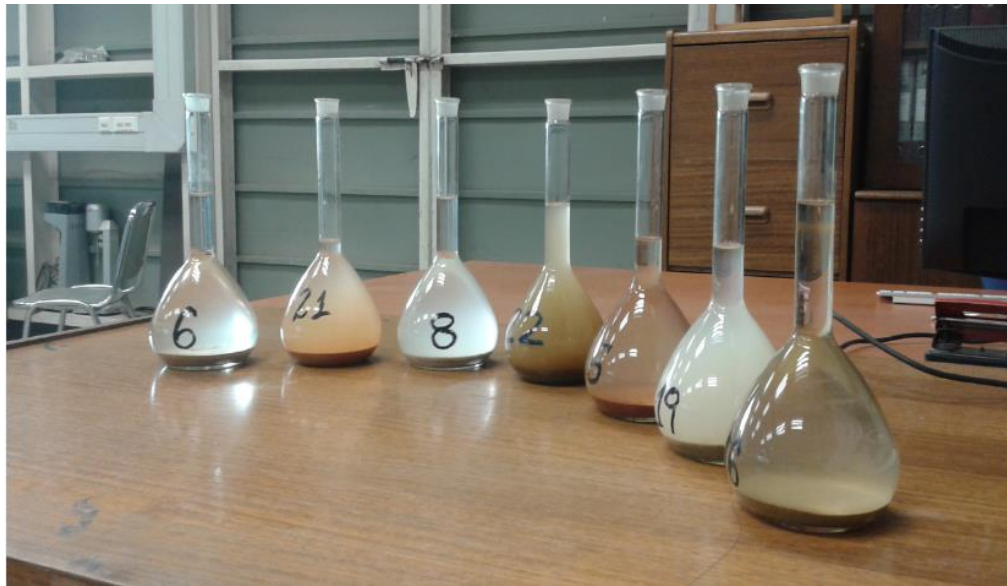
Figura 3.11 Determinación de la gravedad específica mediante picnómetro.
